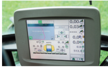
Grâce au moniteur «Greenstar 2600», le conducteur dispose d'un contrôle complet sur le pulvérisateur.
