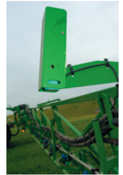
Un capteur à ultrasons qui se trouve à droite et à gauche de la rampe fournit des indications pour la correction de dévers automatique « Boomtrac ».
